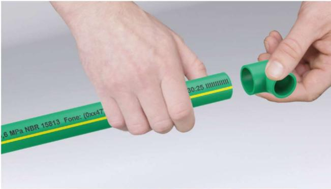
Retire o tubo e a conexão do termofusor, introduza imediatamente a ponta do tubo na bolsa da conexão até a formação dos anéis visíveis formados pelo movimento do material. Respeitar o tempo de acoplamento para a união do tubo e conexões conforme tabela 11 (catalogo técnico).
