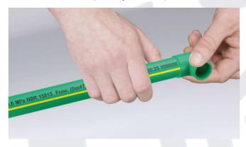
Alinhe a conexão ao tubo durante os primeiros 5 segundos após a termofusão. Caso haja necessidade, após realizar o encaixe, alinhe a conexão em um intervalo de aproximadamente 4 segundos alinhe a conexão em até 15°.
