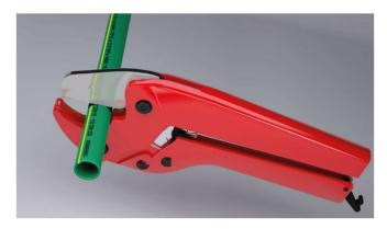
Com o cortador ou com a tesoura, corte o tubo no esquadro.
