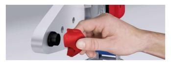
Limpe os bocais do termofusor no final ou em cada intervalo de trabalho com álcool 65° INPM e verifique e está bem ajustado sobre a placa de alumínio do termofusor.
