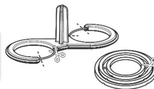
Antes de instalar destaque os fios constantes nas abraçadeiras e anéis de vedação
