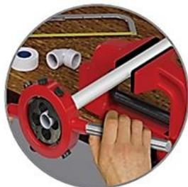
Cortar o tubo no esquadro, retirar toda rebarba e executar a rosca com uma tarraxa, até que a extremidade do tubo fique alinhada com o final da tarraxa.
