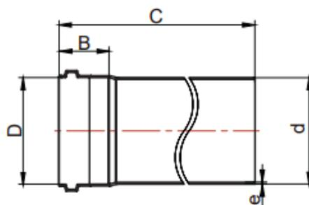
**TUBOS DE PVC ESGOTO PRIMÁRIO 3 M**
