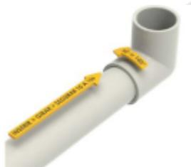
Monte a junta com a camada de adesivo ainda úmida. Encaixe as duas peças, dê ¼ de volta e mantenha fixo por 15s.
