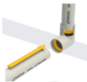
Não lixar. Apenas, remova as rebarbas do corte e limpe a ponta e a bolsa. Confira se existe ajuste com interferência entre essas partes.
