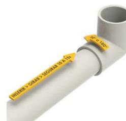
Monte a junta com a camada de adesivo ainda úmida. Encaixe as duas peças, dê ¼ de volta e mantenha fixo por 15s.
