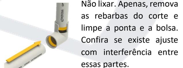
Não lixar. Apenas, remova as rebarbas do corte e limpe a ponta e a bolsa. Confira se existe ajuste com interferência entre essas partes.
