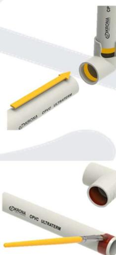
Não lixar. Apenas, remova as rebarbas do corte e limpe a ponta e a bolsa. Confira se existe ajuste com interferência entre essas partes.
