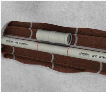
Identifique o ponto, drene a tubulação e abra a região para a manutenção. Corte de forma perpendicular e central o trecho danificado. Tal abertura deve possuir um comprimento maior que duas luvas de correr.
