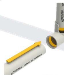
Não lixar. Apenas, remova as rebarbas do corte e limpe a ponta e a bolsa. Confira se existe ajuste com interferência entre essas partes.
