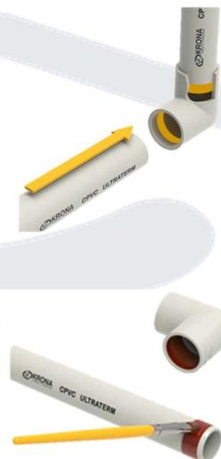
Não lixar. Apenas, remova as rebarbas do corte e limpe a ponta e a bolsa. Confira se existe ajuste com interferência entre essas partes.
