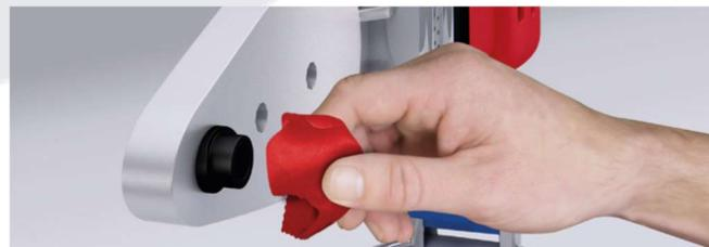
Limpe os bocais do termofusor no final ou em cada intervalo de trabalho com álcool 65° INPM e verifique e está bem ajustado sobre a placa de alumínio do termofusor.
