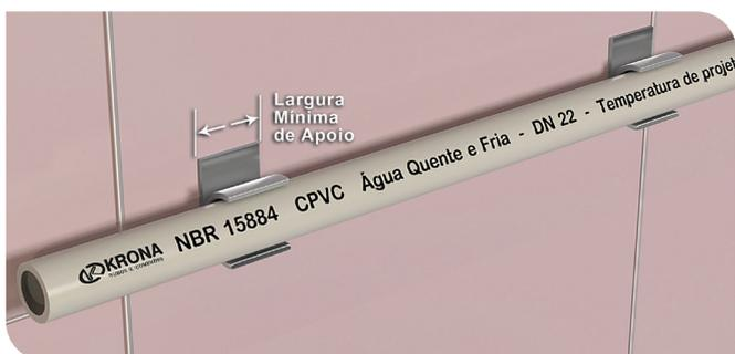
**Ponto Fixo:** Tipo de suporte em que a tubulação fica totalmente fixa. Não permite movimentação.
