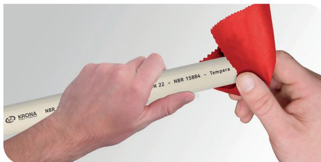
**5º Passo:** Tenha um segmento de tubo novo com comprimento equivalente a duas luvas (B). Lubrifique os dois extremos deste segmento, utilize pasta lubrificante Krona, e monte as duas Luvas de Correr sobre ele (C).
